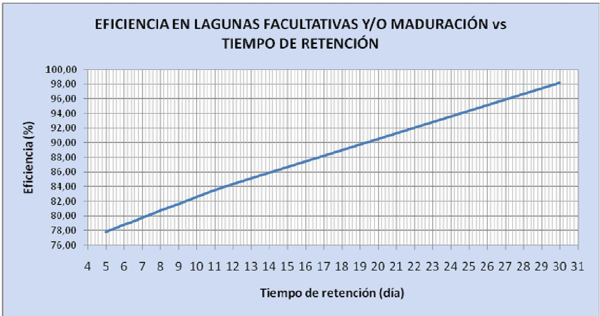
**Figura 5.2. Parámetros para el diseño de las lagunas facultativas y de maduración**
